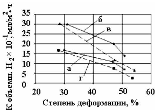
Рис. 1. Изменение показателя коррозии в зависимости от степени деформации при охлаждении арматуры:
