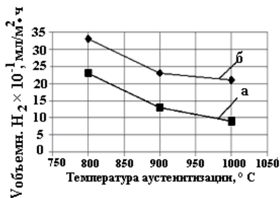
Рис. 4. Изменение показателя коррозии в 10%-ом растворе H 2 SO 4 в воде в зависимости от температуры нагрева; охлаждение:
