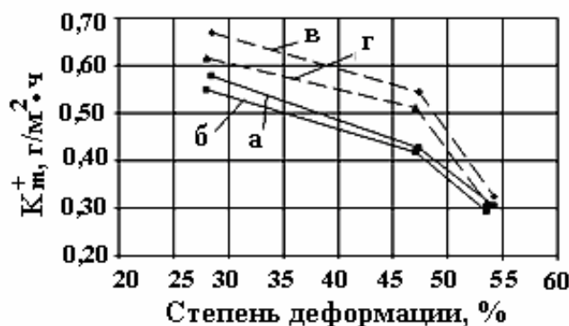
Рис. 2. Зависимость изменения показателя коррозии от степени деформации:
