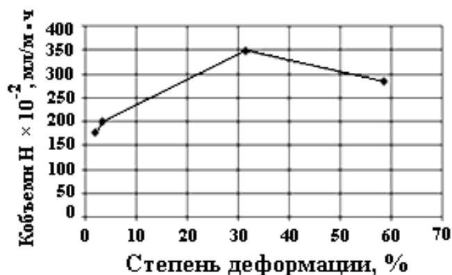
Рис. 6. Зависимость объемного показателя коррозии от степени деформации арматурного стержня при испытании в кислом растворе
