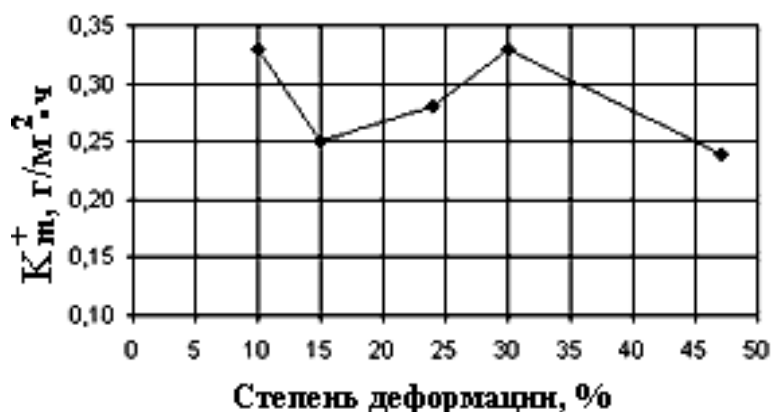
Рис. 7. Изменение массового показателя корозии в зависимости от степени деформации арматурного стержня при испытании на коррозию в водопроводной воде
